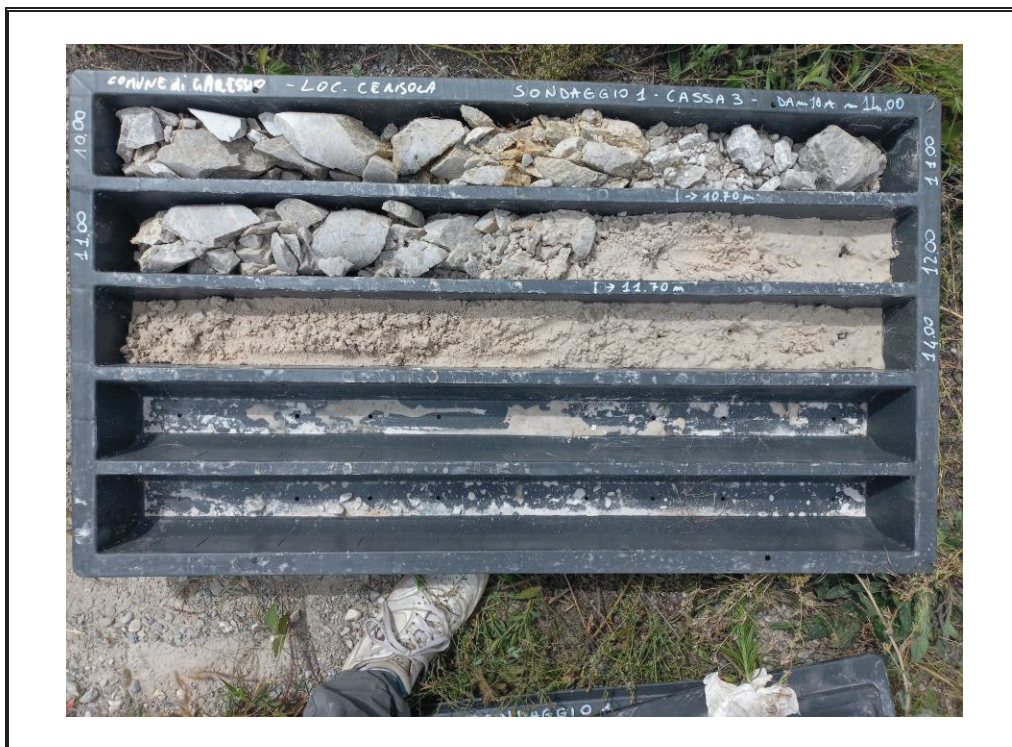
Foto 3: Sondaggio S1 - cassa 3 - da 10.00 m a 14.00 m.
