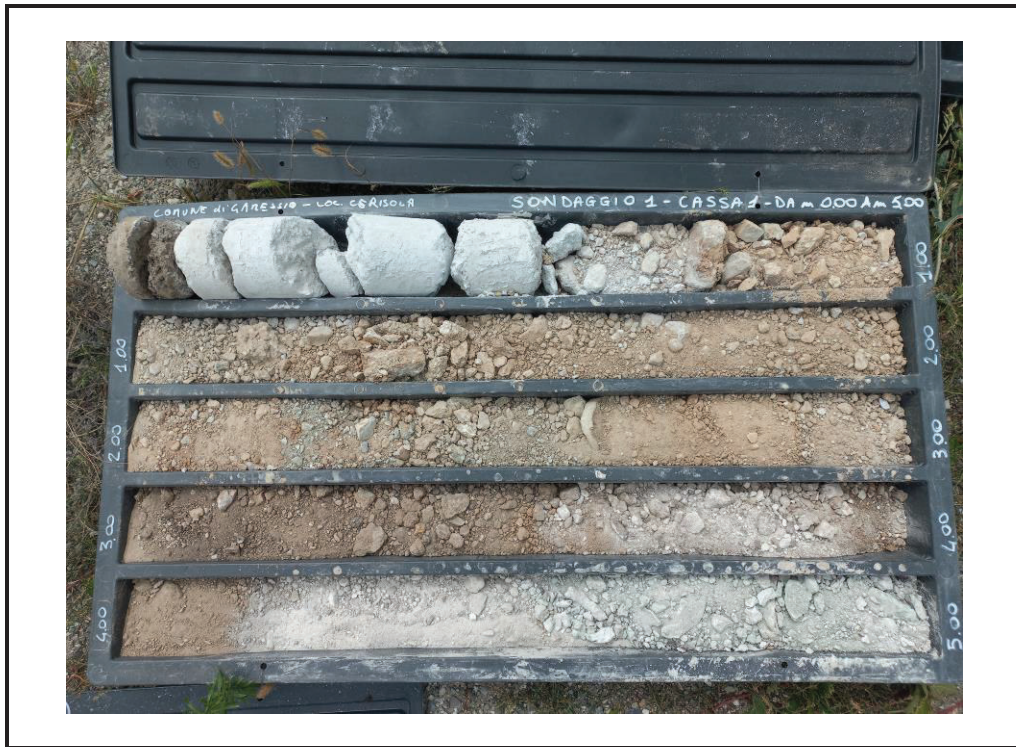
Foto 1: Sondaggio S1 - cassa 1 - da 0.00 m a 5.00 m.
