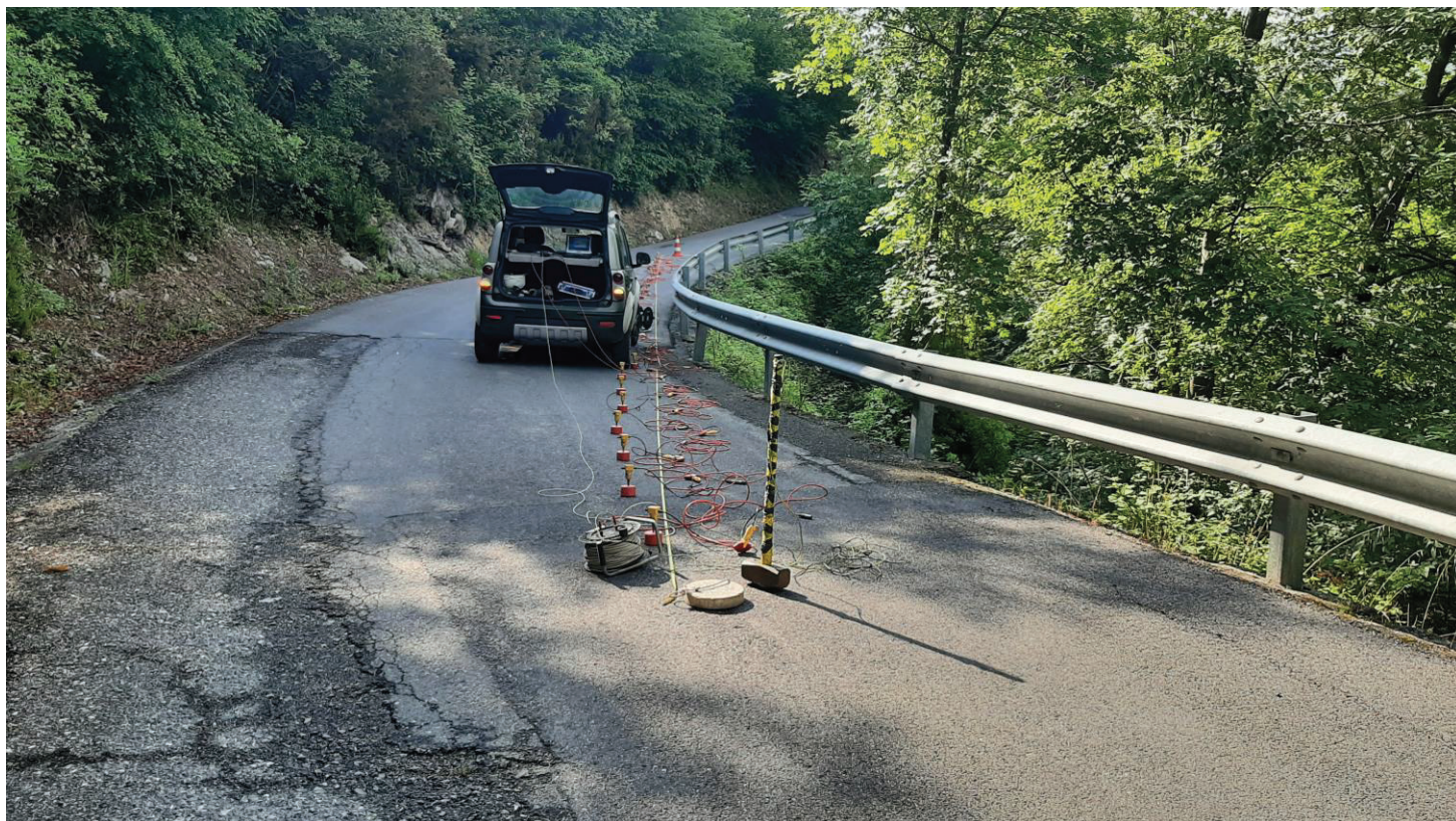
Foto 1 – Esecuzione tomografia sismica a rifrazione e acquisizione Masw
