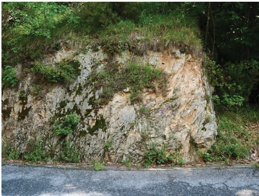
Foto n° 1: Foto ammasso roccioso – notare i vari sistemi di discontinuità e la presenza di fratturazione a franapoggio
